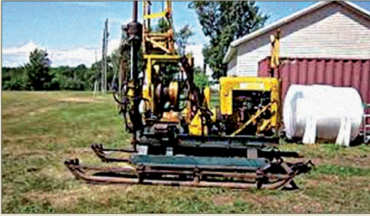
Obr. IV. 23: Souprava Longyear 34 Coredrill – typický a populární zástupce jádrovacích vrtných souprav v druhé polovině 20. století. Přítlak i svěry vrtného vřetene jsou již hydraulické.
