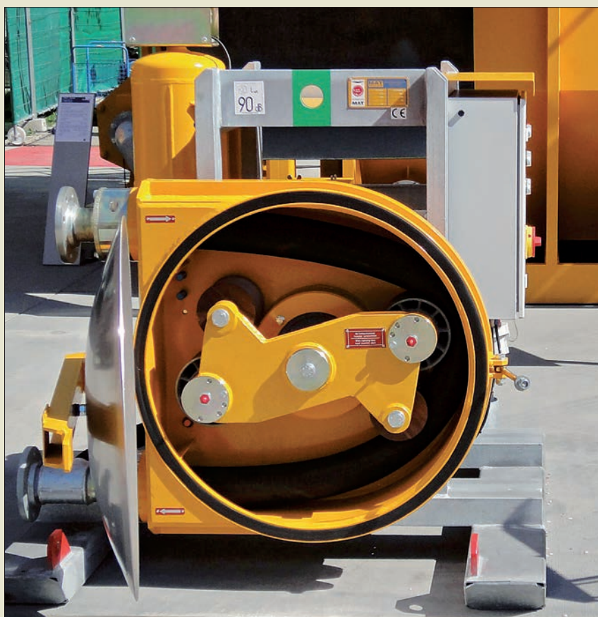
Obr. VI. 46: Pohled do vnitřku hadicového čerpadla firmy Bauer Maschinen na husté stavební kaly se zřetelnými rotačními excentry tlačícími na hadici při vnitřním obvodu skříně
