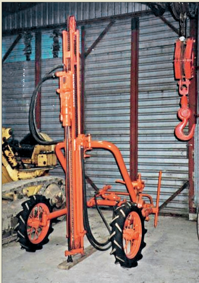
Obr. IV. 15: Příklad velmi úspěšné lehké mobilní pneumatické soupravy typu Wagondrill pro vrtání s rotačním vrchním příklepem, používané zejména v lomech (výrobek americké firmy Gardner-Denver z roku 1939)
