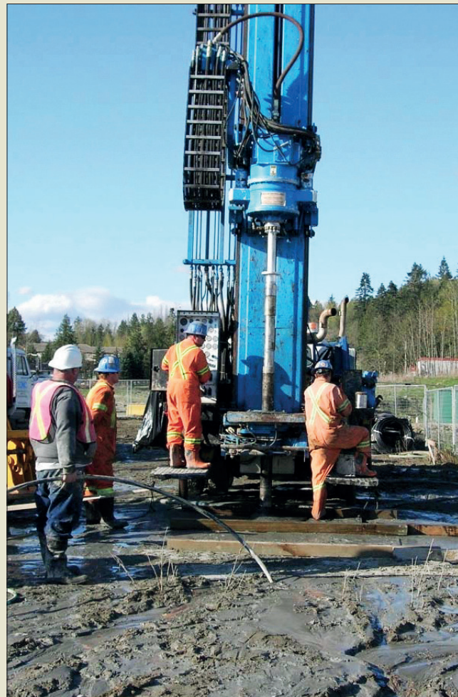
Obr. IV. 30: Moderní souprava pro vrtání metodou Sonic-drilling vybavená obzvláště robustní lafetou s vrtnou hlavou pro vysokofrekvenční vibraci v roce 2010
