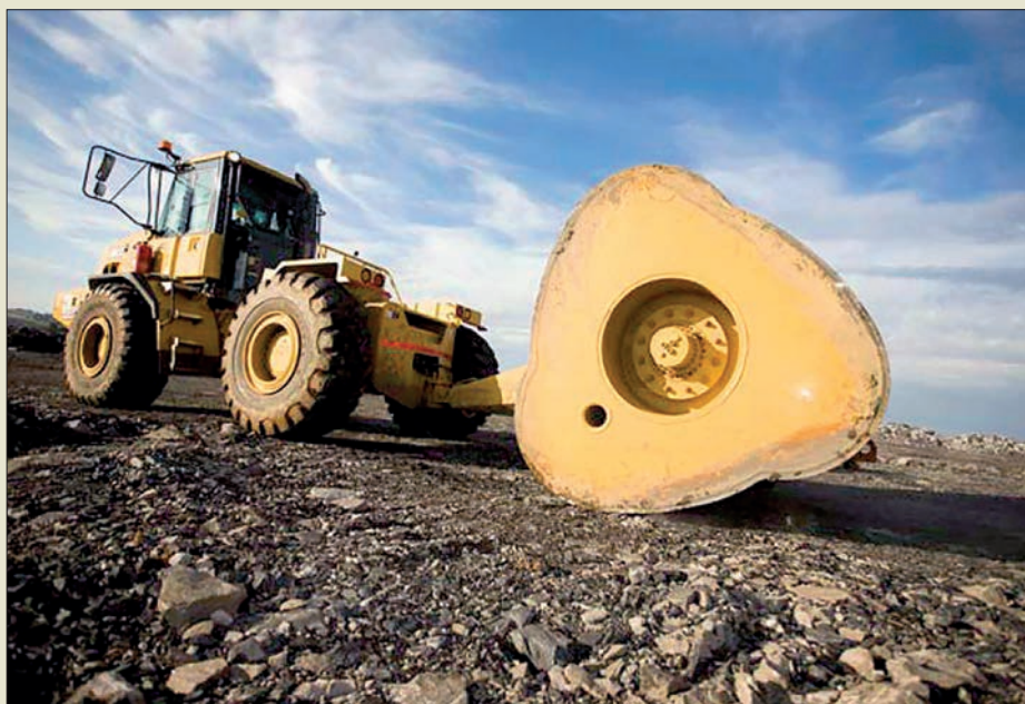
Obr. VI. 108: Zařízení pro rotační nárazové hutnění zemín s trojbokým odvalovacím mechanismem jihoafrické firmy Landpac z roku 2010
