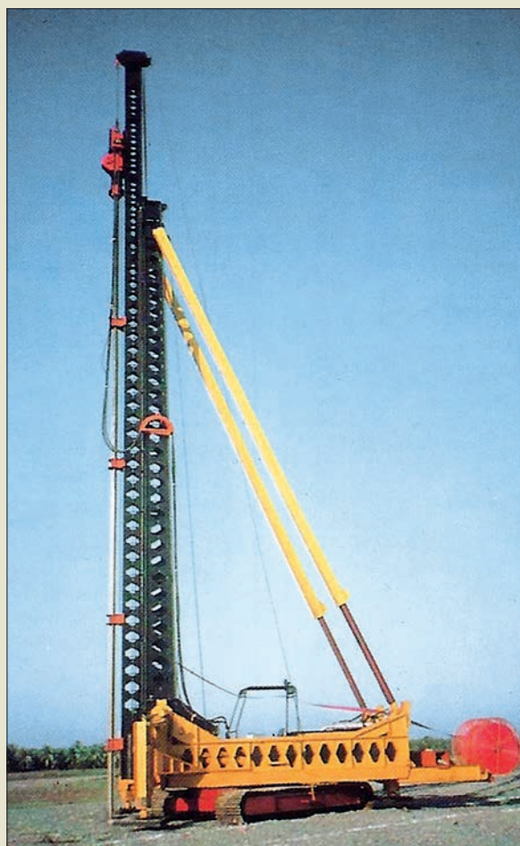
Obr. VI. 118: Těžká vibrační souprava firmy Soletanche pro instalaci geodrénů do hloubek desítek metrů v devadesátých letech
