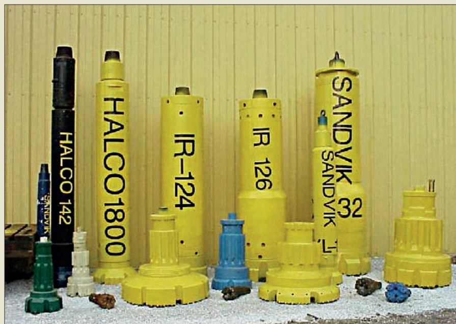
Obr. IV. 19: Různé druhy ponorných kladiv a vrtných korunek na začátku 21. století
