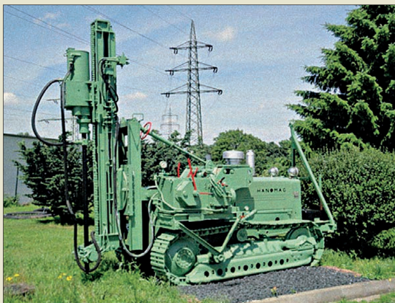
Obr. IV. 32: První univerzální vrtná souprava E9 firmy Hausherr z roku 1959 se shora nasazenou vrtnou hlavou na soutyči
