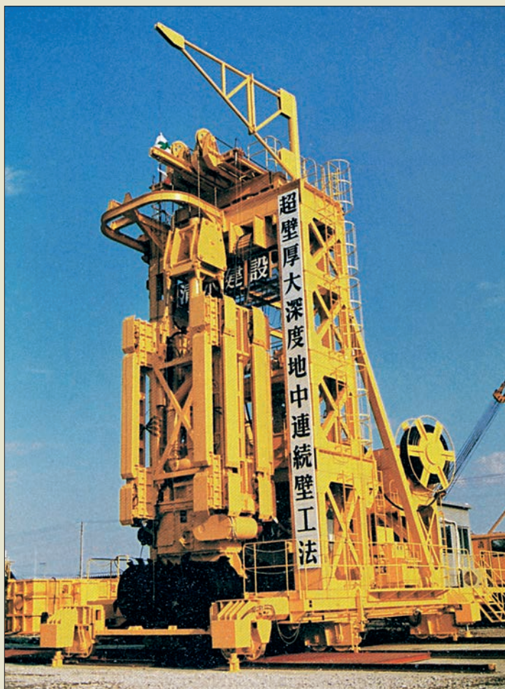
Obr. V. 54: Japonská fréza firmy Tone Boring typu EM 320 na elektrický pohon navržená na začátku devadesátých let pro základové elementy o rozměrech 3,2 x 3,2 m do hloubky až 150 m
