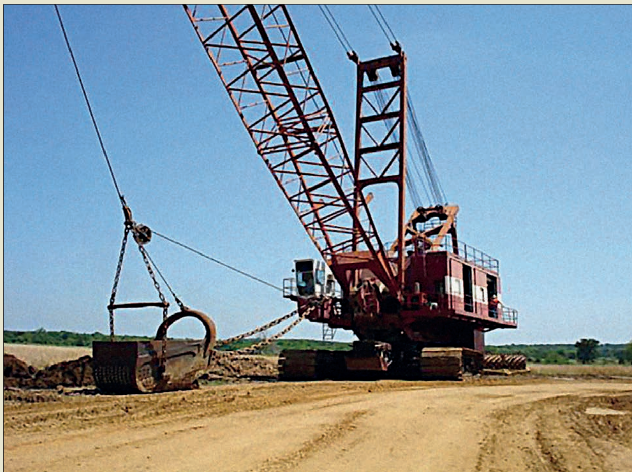
Obr. V. 70: Typický bagr s vlečným korečkem na konci sedmdesátých let v USA; nosič firmy Manitowoc, model 6400, tah na laně 38 t, výložník 53 m s korečkem firmy Hendrix o objemu 10,5 m 3
