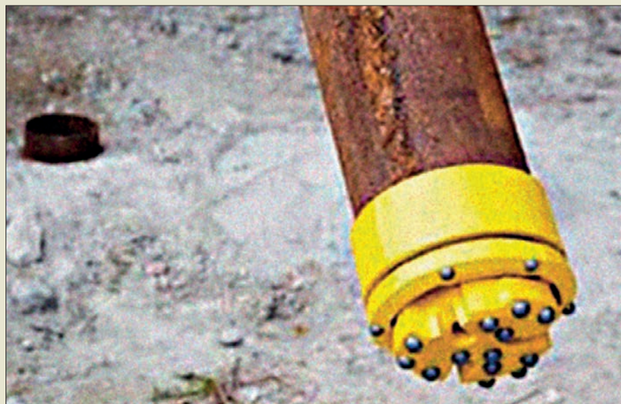
Obr. IV. 27: Pažnicová korunka o průměru 114,3 mm a vrtná korunka ponorného kladiva, systém zavlékané pažnice Symmetrix společnosti AtlasCopco z roku 2000
