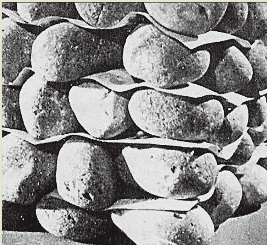
Obr. VI. 101: Model vyztužené zeminy Henriho Vidala při vývoji jeho teorie na začátku šedesátých let, firma Terre Armée
