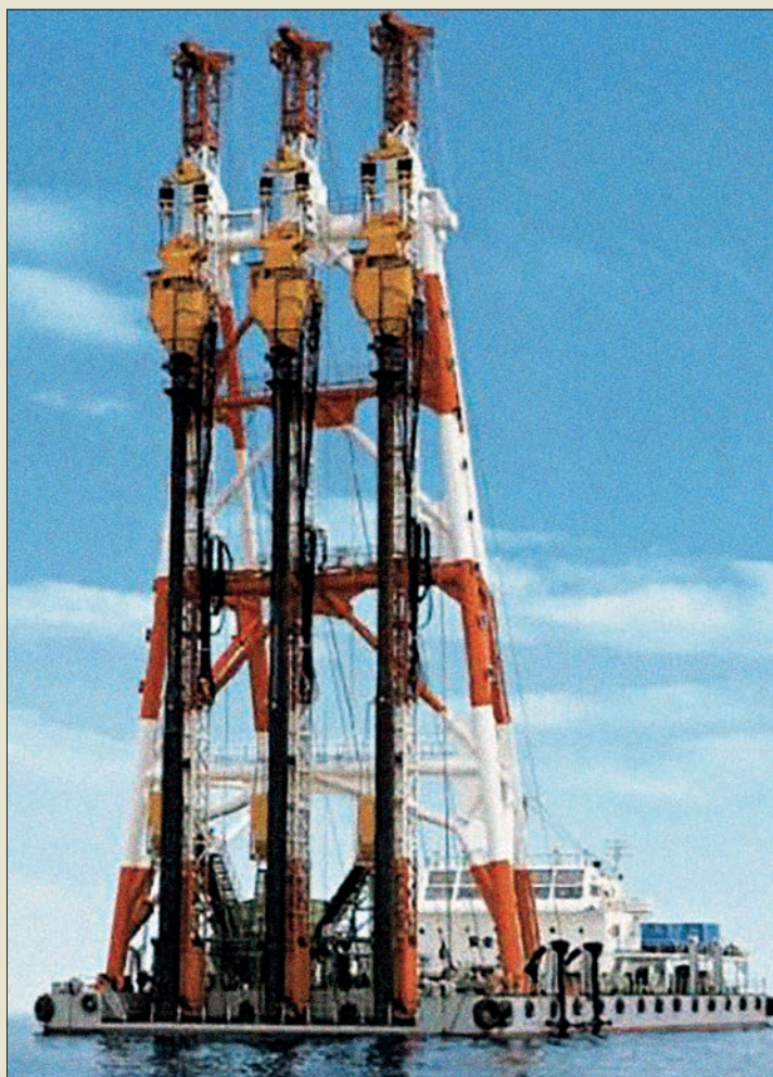
Obr. VI. 75: Jihokorejská těžká námořní plně automatizovaná souprava ESC-50 firmy Eunsung O&C pro provádění pískových zhutňovacích pilot s třemi výpažnicovými jednotkami o průměru 80 cm a s dosahem do hloubky 50 m pod hladinu roku 2010
