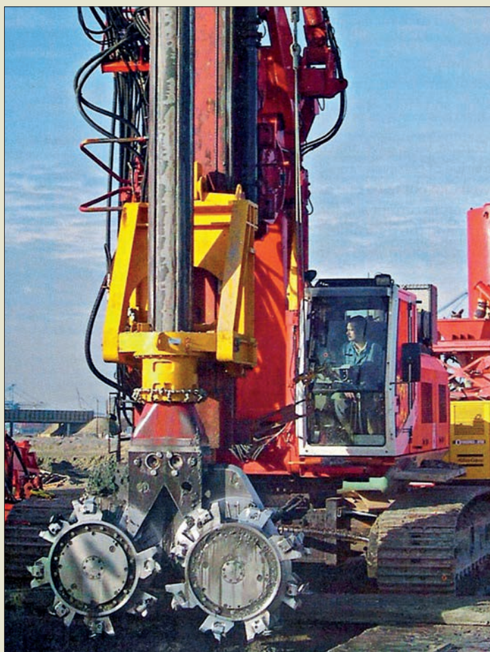
Obr. VI. 63: Hydrofréza pro soil-mixing CSM na nosiči Bauer BG22 ve verzi s úpravami firmy Soletanche-Bachy pro elementy 2,4 x 0,5 m nebo 2,8 x 1,2 m roku 2009
