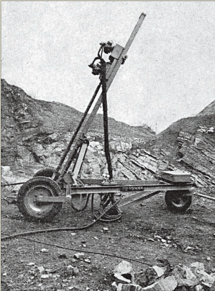
Obr. IV. 18: Lehká vrtná souprava firmy Stenuick typu Record HS Universelle, na jejímž prototypu André Stenuick zkoušel v roce 1950 nový způsob vrtání ponorným kladivem.
